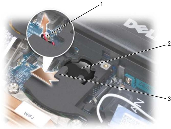
1 connecteur de la pile bouton 2 pile bouton 3 mylar
